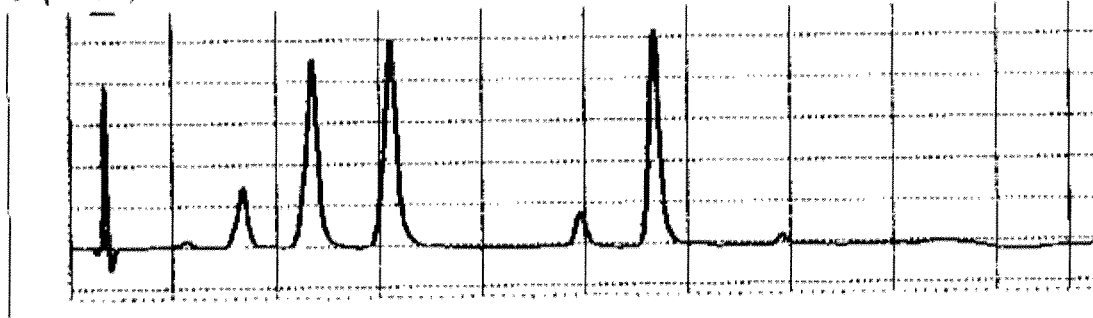
Şekil-3 Mürekkep yaş analizinde kullanılan boya ve pigment standartlarının kromatogramı.
